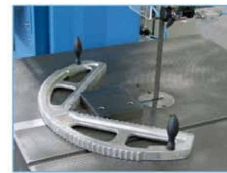
Materialhalter für kleine Werkstücke und zum Kontursägen. Material holder for small workpieces and contour cutting.
