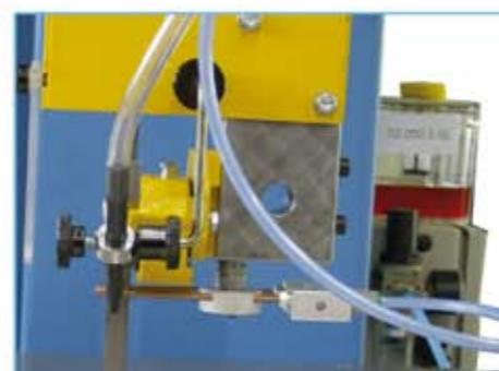
Sprüheinrichtung Micro mist spraying device Micropulvérisation du lubrifiant
